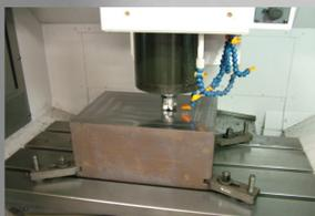
Processo de usinagem de Desbaste
