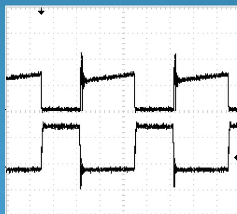
Figura 3. Tensão do driver ( abaixo) ,tensão Drain - source ( abaixo). (10V/div; 50V/div; 5μs/div).
