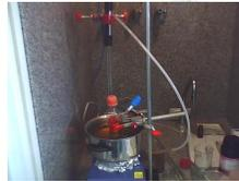
Figura 3: Sistema usado nas reações de ATRP
