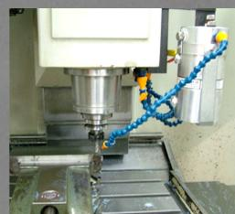
Sistema MQL acoplado externamente à máquina-ferramenta (CNC Dyna Myte)
