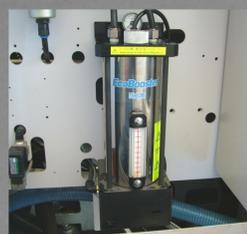
Sistema MQL integrado à máquina-ferramenta (CNC Okuma)
