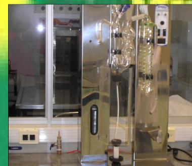
Figura 02: destilador de Kjeldahl
