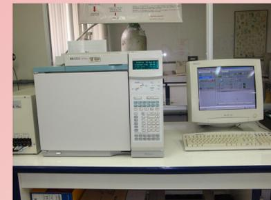
Figura 6: Aparelho cromatógrafo a gás
