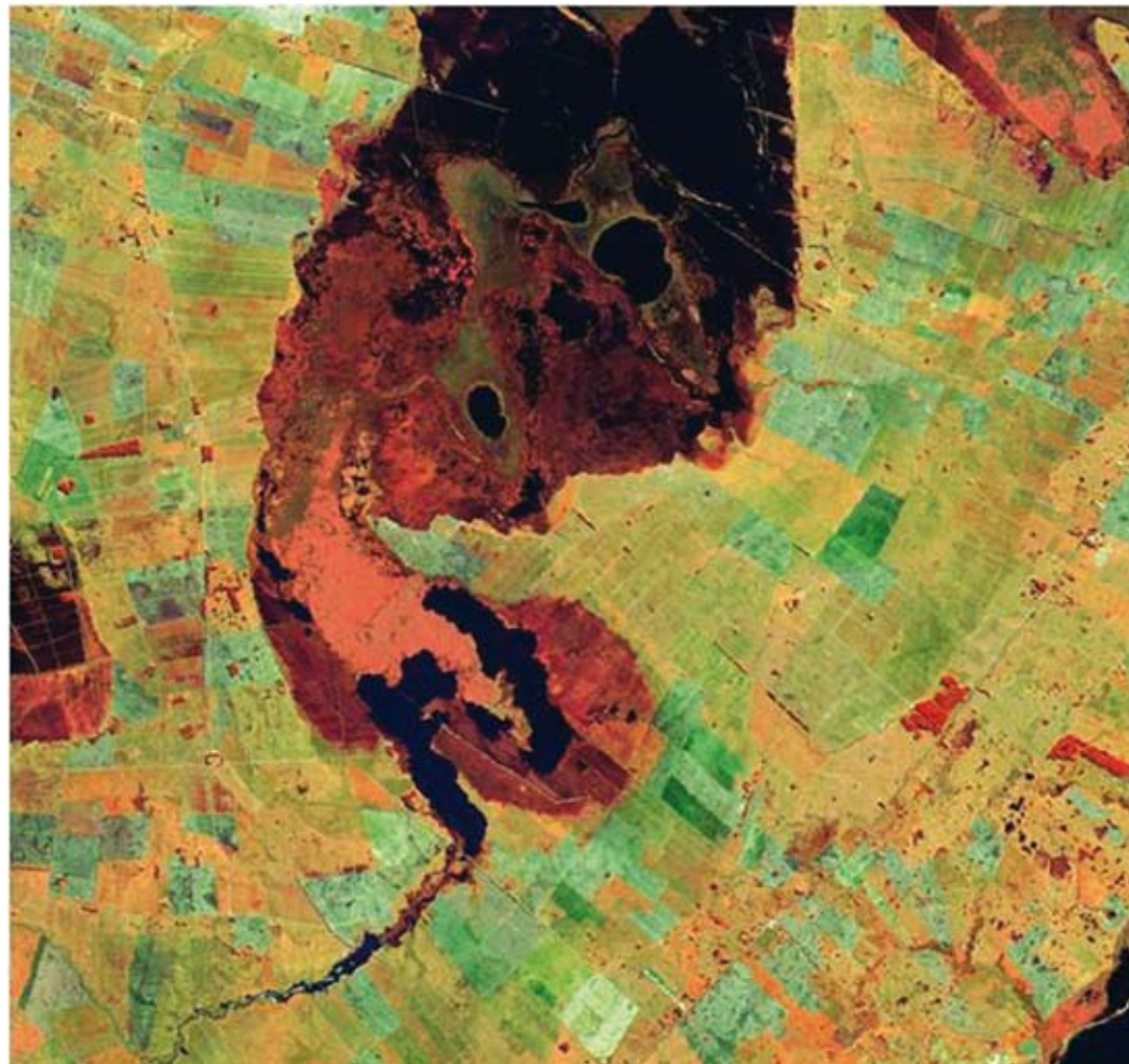
Fig. 5: Parte de cena Landsat em composição infravermelha (4R 5G 3B) e em cores reais (3R 2G 1B) do Município de Santa Vitória do Palmar, exemplificando como diferentes composições podem valorizar feições diversas em função da cor atribuída a cada pixel
