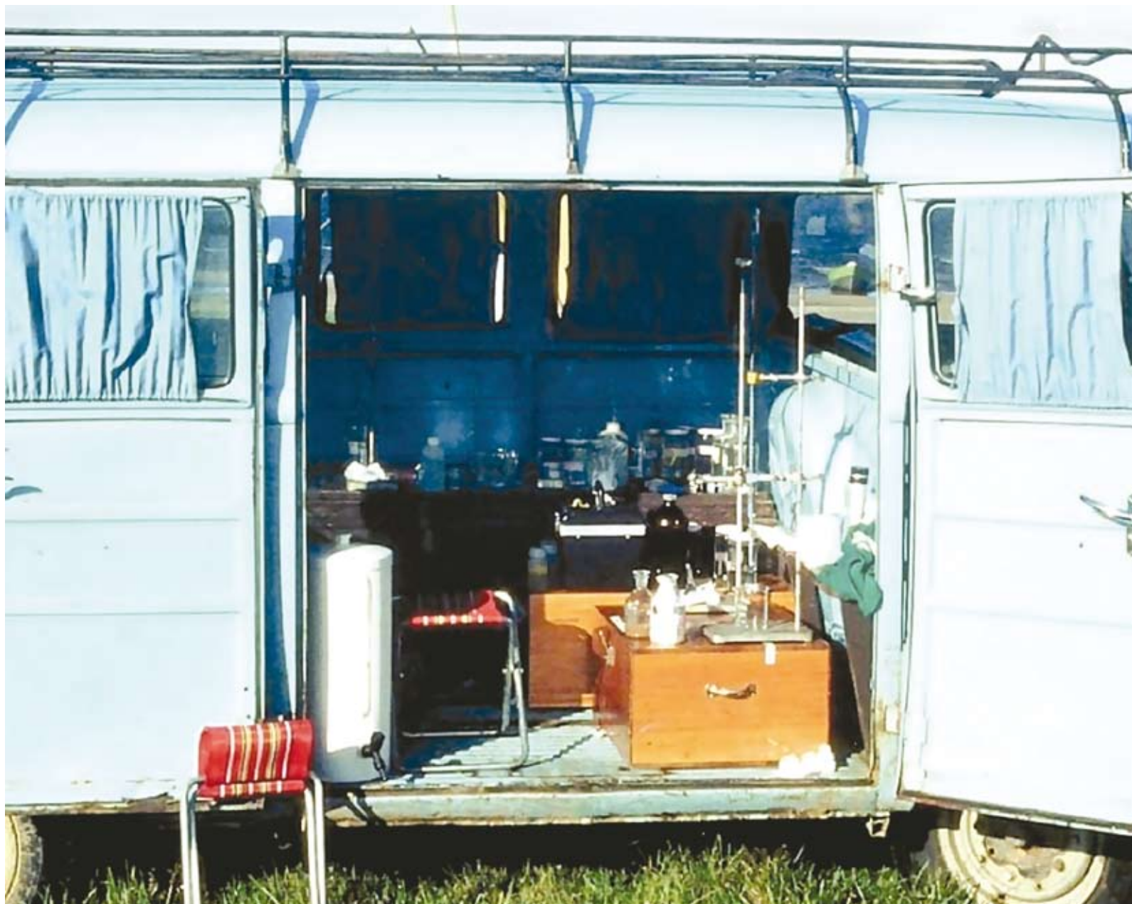
Fig. 11: "Laboratório-móvel", versão 1980, apto para fazer análises químicas de titulação e espectrofotometria, Lagoa de São Simão, Município de Mostardas
