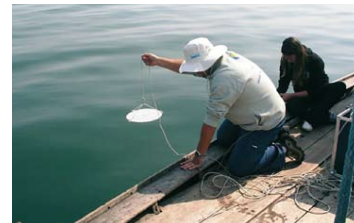
Fig. 13: Medição da transparência da água da lagoa por meio do Disco de Secchi
