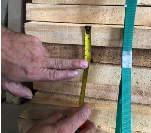
Figura 17 – Medição da bitola com trena
