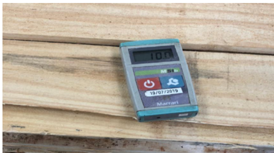
Figura 22 – Aparelho manual para medir a umidade da madeira com o número previsto pelo Lindomar
