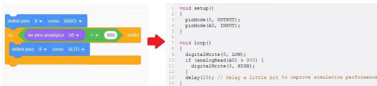
Figura 15 – Geração do equivalente textual do código em diagrama de blocos
