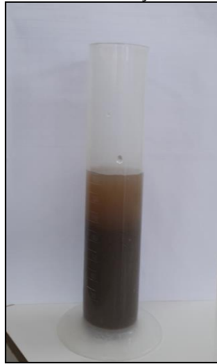
Figura 2 – Adensamento de lodo de ETA com diferentes dosagens de ozônio e períodos de sedimentação
