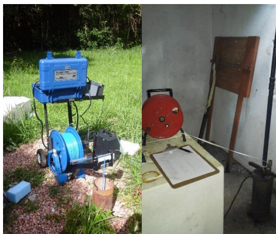
Figura 2 – Detalhe da filmagem do poço P02 e do teste de aquífero do poço P01
