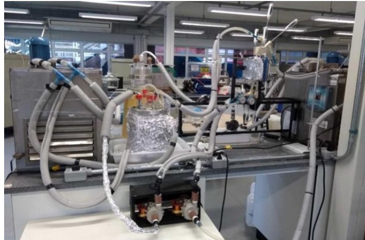
Figura 3 – Sistema de destilação por membranas em escala de bancada do laboratório Aquário/FEEVALE
