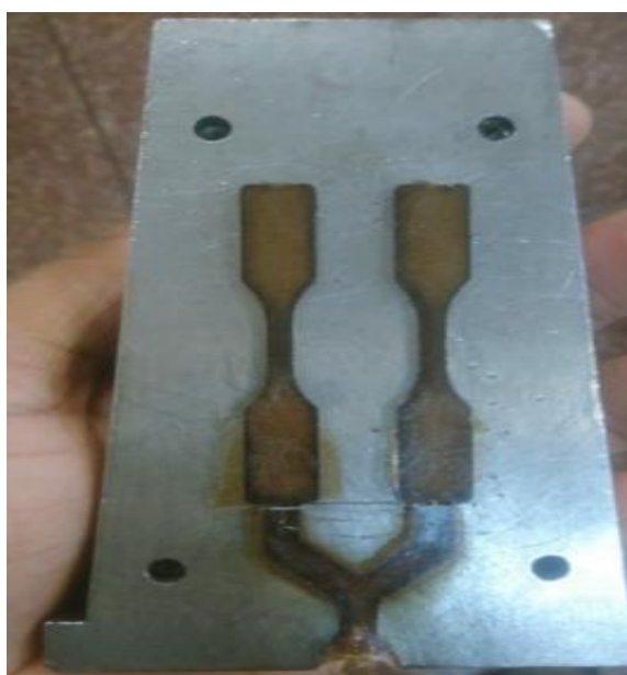
Figura 4 – Molde utilizado para confecção dos corpos de prova segundo ASTM D-638
